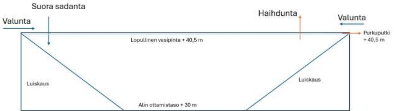
Kuva 3-2. Konseptualisointi suunnitellun kaivu- ja ottamisalueen vesitaseen keskeisistä tekijöistä ja huomioitavista asioista. Kuva ei ole mittakaavassa.
